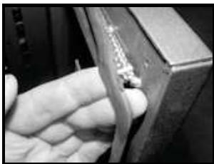
Illustration F10: Vérifiez le joint d'étanchéité de la porte de chargement.
